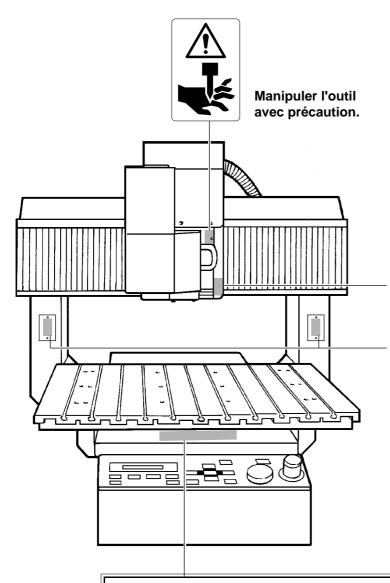
Ne pas insérer vos doigts entre la tête et la plaque Z quand l'appareil est en marche.
