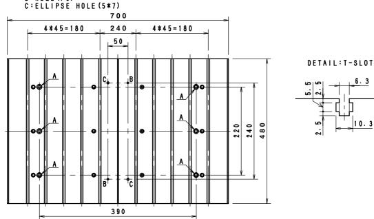
A∶HOLE(FOR M6 HEXAGON SOCKET HEAD CAP SCREWS) B∶HOLE(∳5) C∶ELLIPSE HOLE(5\*7)
