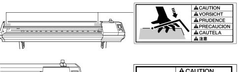
Manipuler avec précaution pour éviter de se coincer les doigts lors de la fermeture du couvercle de devant.
