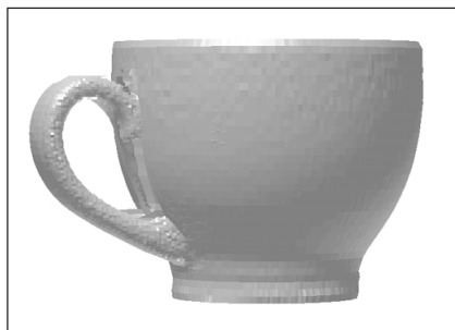
Scannérisation rotative (avec finition par rescannérisation)
