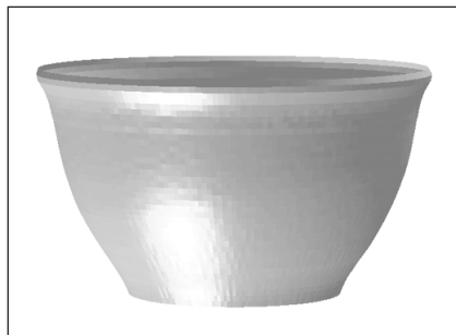
Scannérisation rotative Pas de 1,4 mm x 1,6 degré Temps de scannérisation de 3 mn 30 s
