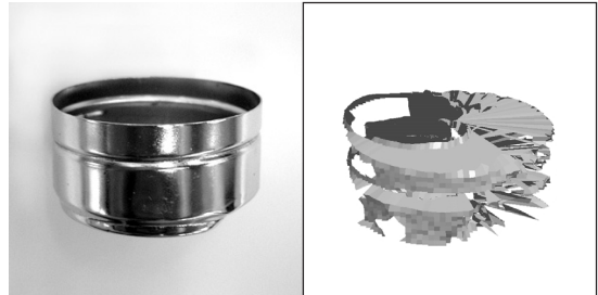
Objet métallique Scannérisation rotative Pas : 1,0 mm x 3 degrés
