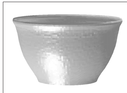
Scannérisation planaire Pas de 1,4 mm x 1,4 mm Temps de scannérisation de 6 minutes
