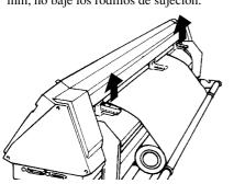
Levante las palancas de carga de la hoja Coloque los topes de forma que toquen ligeramente los bordes del rollo y fíjelos en su lugar apretando los tornillos.
