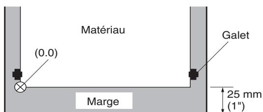
Place le point d'origine en laissant une marge de 25 mm à partir du bord avant du matériau.
