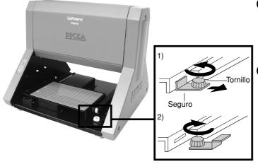
1 Antes de utilizar el equipo, retire los tornillos y el seguro como se muestra en la figura.
