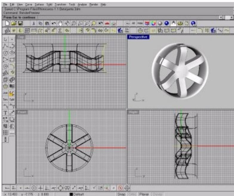
Les bâtons étant bien avancés nous allons passer maintenant à la jante proprement dite. Créez dans la vue de dessus le profil d'une jante, à l'aide de cette courbe créez la jante par une surface de révolution : fonction "Surface Revolve", "déformable with 10 contrôle points". Faites en sorte que les bâtons dépassent légèrement du diamètre de la jante.
