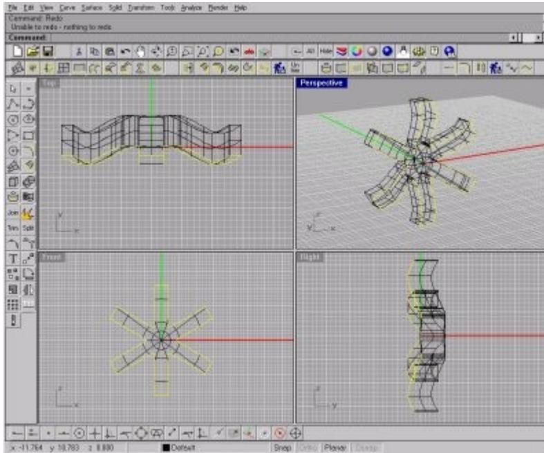
Nous allons nous servir de ses lignes de bords pour donner de l'épaisseur à nos bâtons. Sélectionnez la courbe, cliquez sur l'icône "Extrude Straight", entrez une valeur numérique ou bien cliquez deux points à l'écran pour donner la distance d'extrusion. Une fois votre extrusion réalisée, faites une copie de la surface du départ à l'arrière de vos bâtons pour pouvoir boucher la surface avec la fonction "Join".
