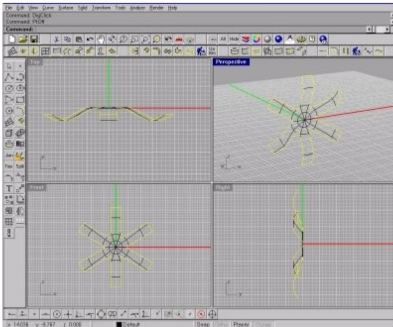
A l'aide de la fonction "Split" découpez la surface par les courbes projetées, supprimez les morceaux de surface inutiles. Nous devons maintenant récupérer les courbes de contour de la surface pour pouvoir extruder nos bâtons. Pour cela allez dans le menu "Curve from Object", et utilisez la fonction "Duplicate Border"
