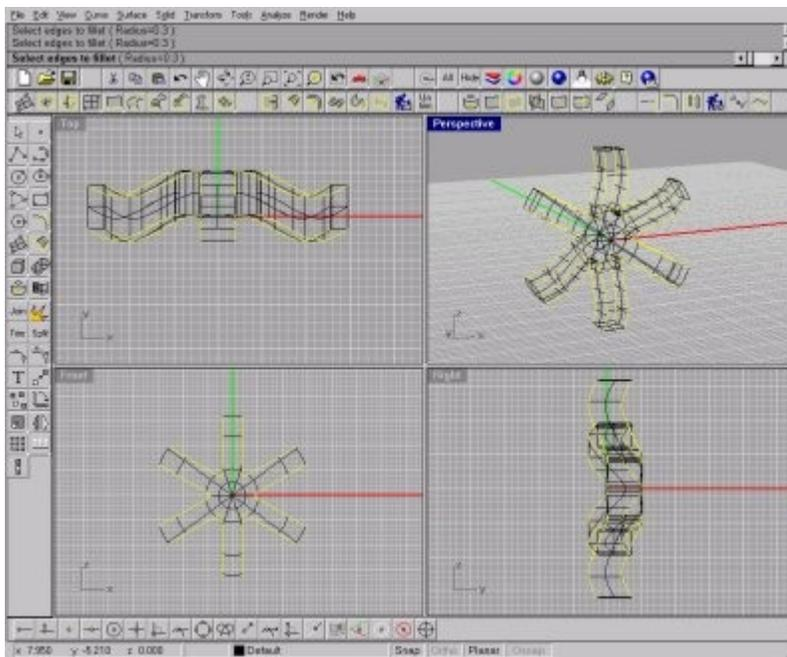
Pour donner un aspect un peu moins brut à nos bâtons nous allons passer quelques rayons de raccordements entre les surfaces. Pour cela nous devons utiliser la fonction "Fillet Edge" dont l'icône se trouve dans le menu "Solid". Cliquez sur l'icône, sélectionnez les bords de surfaces sur lesquels vous voulez passer un rayon
