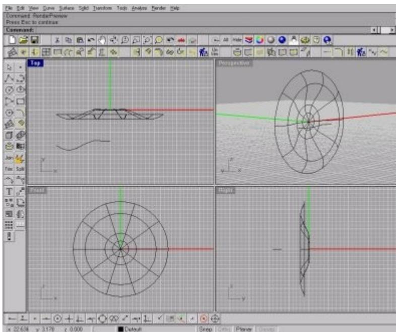
A l'aide de cette courbe créez une surface de révolution qui constituera le flanc de votre jante: fonction "Surface Revolve": "deformable with 10 controle points"
