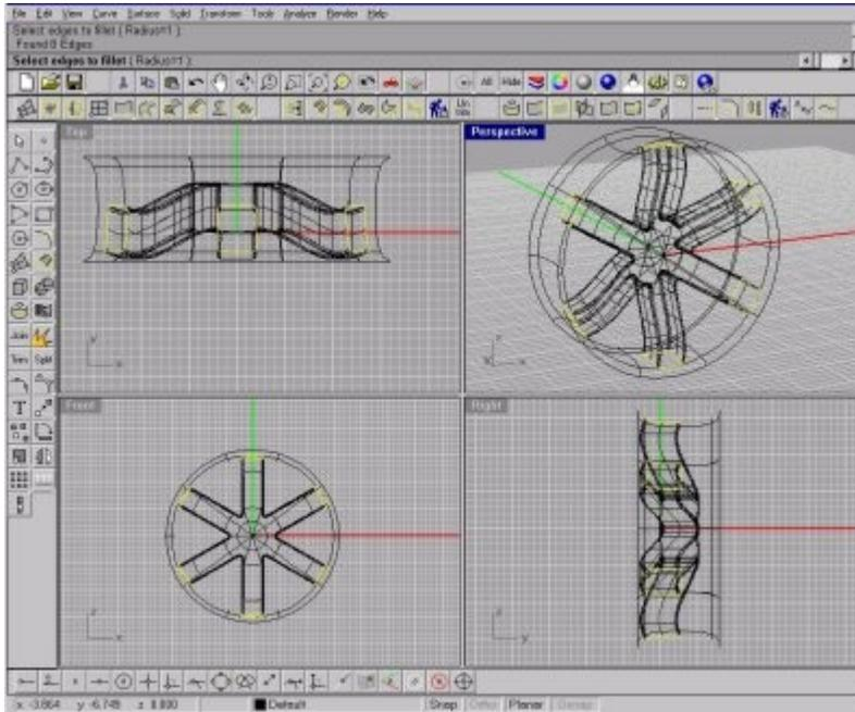
Maintenant nous allons effectuer une opération booléenne entre la jante et les bâtons : menu "Solid tools", "Boolean Différence", cliquez la jante, cliquez les bâtons. Pas mal non ? Il ne nous reste plus qu'à passer encore quelques rayons et nous serons au bout de nos peines. Cliquez sur l'icône "Fillet Edge", sélectionnez tous les bords à l'extérieur des bâtons, entrez une valeur de rayon de raccordement et validez.
